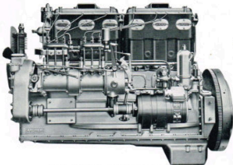
"GARDNER" 6LW TYPE HIGH-SPEED HEAVY OIL ENGINE.
